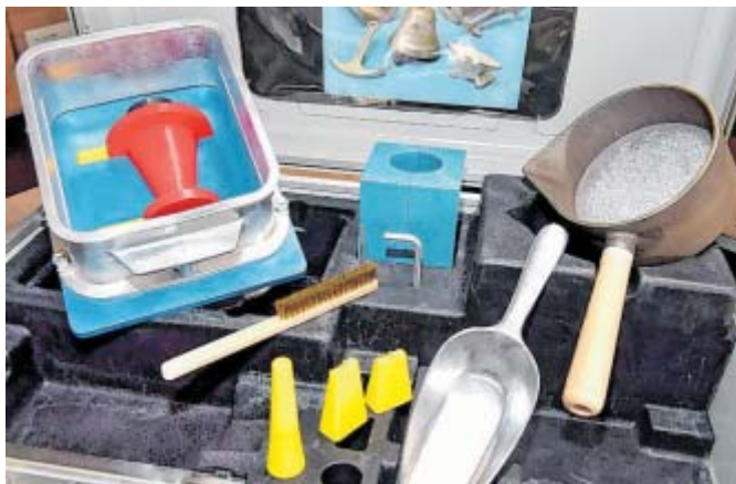
Für Berufsschulen: Ein Koffer enthält alles, was man zur Herstellung einer kleinen Glocke braucht. Neben dem Modell (rot), den Kernkästen sowie unter anderem eine Pfanne mit einem Metall, das schon auf einer Herdplatte flüssig wird. Auszubildende erlernen damit das Prinzip des Metallgießens.
