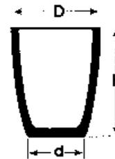
Bis zur Größe A 8 normalerweise unglasiert, ab A 10 glasiert (bei kleineren Tiegeln auf Wunsch ebenfalls möglich). Bis zur Größe A 350 standardmäßig mit Ausgusstülle. Bei größeren Tiegeln auf Wunsch auch möglich.
