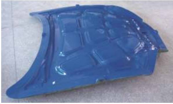
Werkzeug aus GC 080 zur Herstellung von Verstärkungen für Motorhauben
