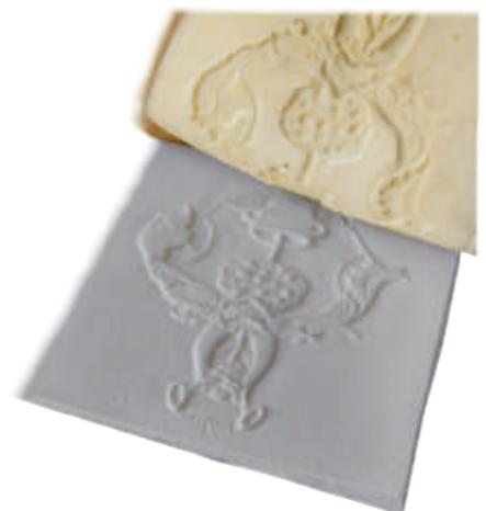
Der dickflüssige Latex wird mit einem Holzspatel vorsichtig auf das soeben hergestellte Tonrelief aufgetragen und so verteilt, dass eine gleichmäßige Oberfläche entsteht. Das Material benötigt für das Aushärten, abhängig von der Schichtdicke der Latex und der Umgebungstemperatur, 4–5 Tage. Danach wird die fertig ausgehärtete Form von dem Tonrelief vorsichtig abgenommen.
