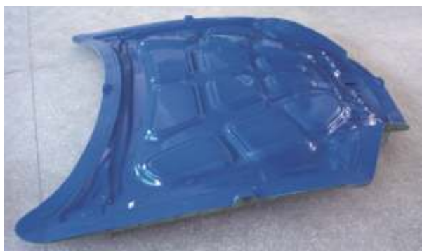
Werkzeug aus GC1 080 zur Herstellung von Verstärkungen für Motorhauben
